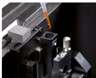
Регулируемый кюветодержатель для проб малого объема
