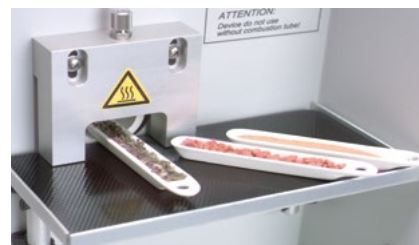
Высокотемпературный модуль для разложения твердых проб
