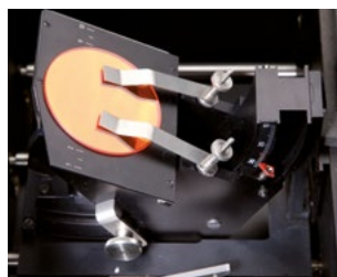
Приставка для определения абсолютного коэффициента отражения
